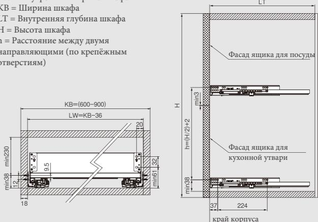
монтажные отверстия направляющих (мм)
