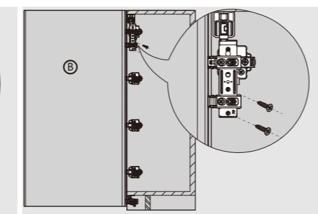
Заделайте монтажную пластину подвеса при помощи шурупов
