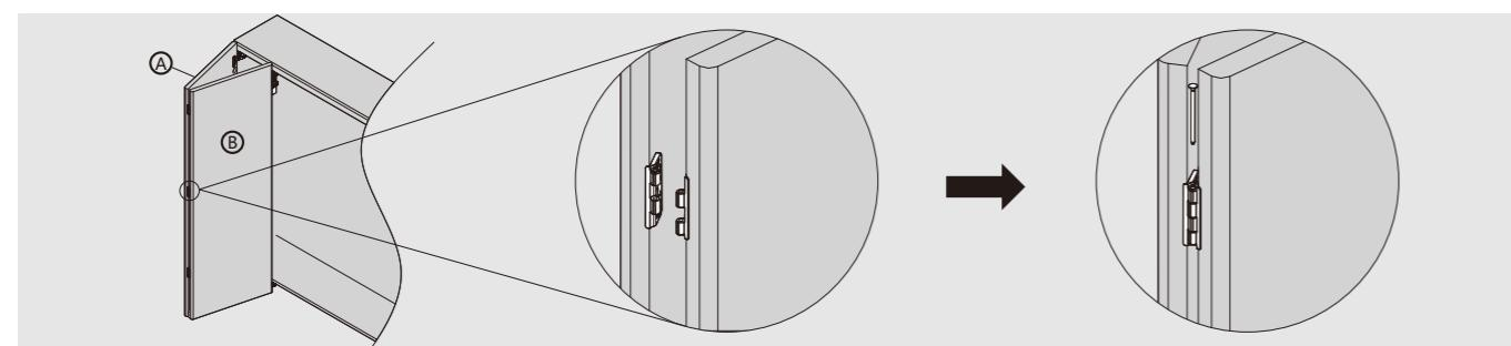
Заделайте складную петлю, используя соединительный вал
