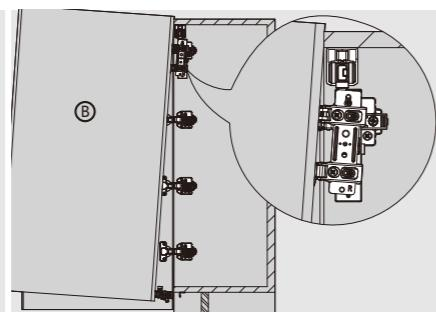
Навесьте дверь B с помощью подвеса на верхний ролик
