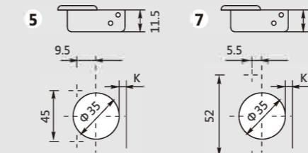
Используйте эти формулы, чтобы определить тип петли, расстояние сверления «K» и высоту монтажной планки «H» для каждого варианта установки двери
